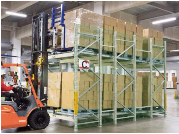
1. 先行するパレットが出庫後、約20秒後にセンサーローラが持ち上がりセパレーターが解除されます。
